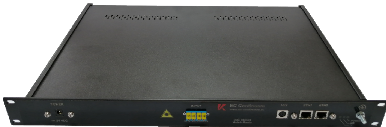
Интеррогатор DOI-143 в 4-портовом исполнении
