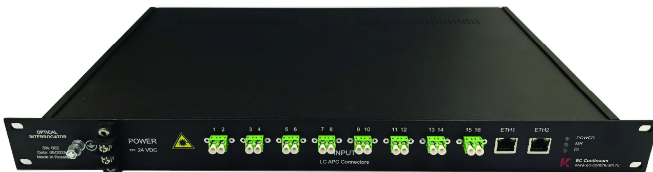
Интеррогатор DOI-143 в 16-портовом исполнении
